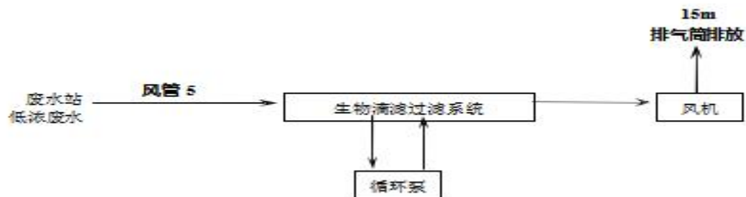
图 4.1-2 废水站低浓废气处理工艺流程图
